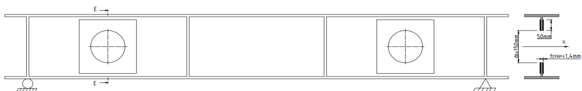
Hình 25. Mặt cắt của dầm khi khoét lỗ tròn và gia cường thêm 3-CFRP
