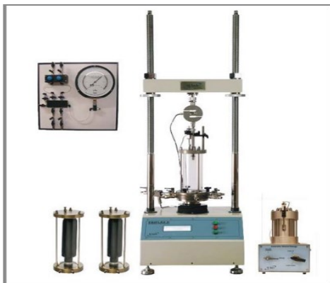
Hình 2. Hệ thống thí nghiệm 3 trục bán tự động trong phòng
