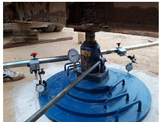
Hình 3. Thí nghiệm đo mô đun đàn hồi nền đường bằng bàn nén hiện trường
